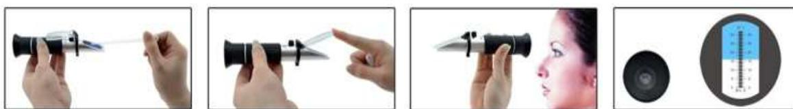
Después de cada uso, limpie el instrumento con un paño suave y húmedo. No exponga el instrumento en condiciones húmedas de trabajo, y no sumergir el instrumento en el agua. Es un instrumento óptico. Esto requiere un cuidadoso manejo y almacenaje. Un uso inadecuado puede causar daño a los componentes ópticos y a su estructura básica. Con un buen cuidado, este instrumento proporcionará varios años de servicio.
