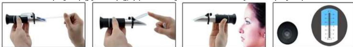
Po każdym pomiarze czyścimy instrument miękką ściereczką. Nie wolno zanurzać urządzenia w wodzie ponieważ części optyczne staną się bezużyteczne. refraktometr jest instrumentem optycznym. Wymaga delikatnego używania i przechowywania. Wtedy będzie służył przez lata dając dokładne pomiary.
