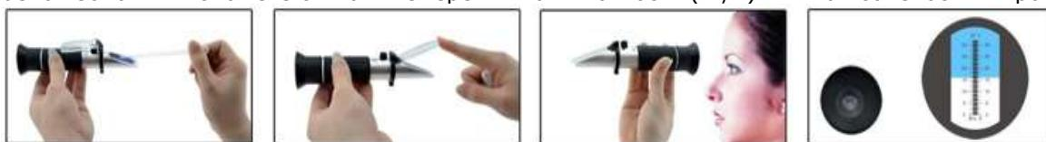
После измерения протрите призму мягкой тряпочкой. Не опускайте прибор в воду, поскольку внутри прибора может образоваться конденсат и вывести рефрактометр из строя. Рефрактометр является высокоточным оптическим инструментом, с которым следует обращаться с особой осторожностью. При правильном использовании прибор прослужит многие годы.
