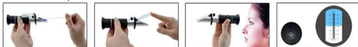
Nettoyer le prisme après usage avec un chiffon doux. Ne jamais immerger l'appareil dans l'eau. Il peut se couvrir de buée à l'intérieur et devenir inutilisable. Le réfractomètre est un instrument de précision. Et doit être manipulé avec soin. Il peut ainsi conserver sa fonction durant de nombreuses années.
