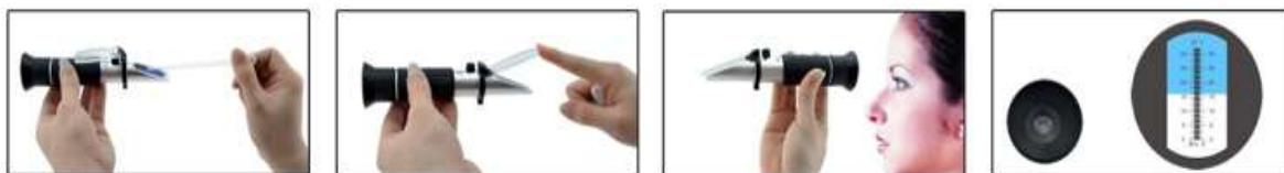
Na gebruik moet u het prisma met een zachte doek schoonmaken. Stop het apparaat niet in het water. Het kan dan van binnen beschadigen en onbruikbaar worden. De refractometer is een optisch precisie instrument en moet voorzichtig behandeld worden. Op deze wijze kan het zijn functie vele jaren uitoefenen.
