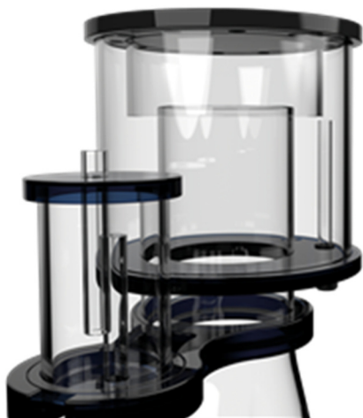
Fig. 3: Nel bicchiere di raccolta della schiuma è presente un tubo di troppo pieno regolabile in altezza. Da lì, l'acqua può essere portata dal bicchiere di raccolta in un contenitore in piedi accanto allo schiumatoio. Assicurarsi che non possa traboccare dal contenitore.
