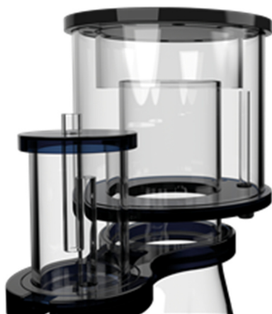
Abb. 3: Im Schaumtopf befindet sich ein höhenverstellbares Überlaufrohr. Von dort kann das Wasser aus dem Schaumtopf in einen neben dem Abschäumer stehenden Behälter geleitet werden. Dabei ist darauf zu achten, dass der externe Behälter nicht überläuft.
