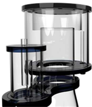
Рис. 3: В поролоновой чаше есть регулируемая по высоте переливная трубка. Оттуда вода может быть направлена в ёмкость рядом со скиммером. Убедитесь, что внешний контейнер не переполняется.
