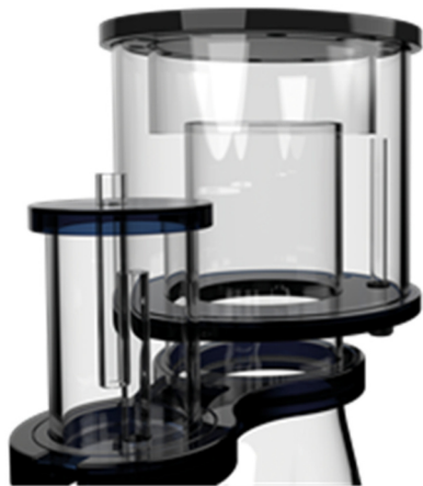
Fig. 3: Er is een in hoogte verstelbare overlooppijp in de schuimbeker. Daar vandaan kan het water van de schuimbeker naar een container naast de afschuimer geleid worden. Zorg er wel voor dat de externe container niet overloopt.
